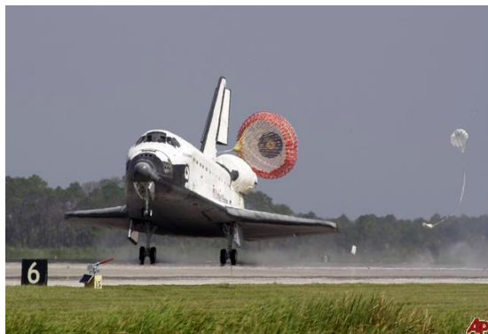
Pilt 5. NASA Kosmoselennuk Shuttle, mis erineb tavalennukist välimuselt vaid põhjakatte materjali poolest, mis ei lase lennukil atmosfääri sisenedes põlema süttida. Pildi autoriõigused: NASA
