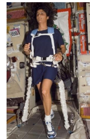
Pilt 1 Rahvusvahelises kosmosejaamas kasutatav jooksulint, kuhu astronaut kinnitatakse traksidega. Traksid on vajalikud, sest muidu hõljuks astronaut jooksulindilt minema. Pildi autoriõigused: NASA
